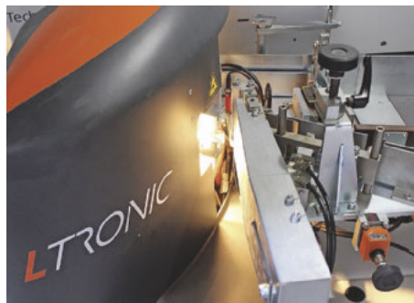
/ Energieeffiziente Technologie für Nullfugen: LTronic aktiviert die Funktionsschicht von Laserkanten per Bestrahlung mit Nahinfrarot.
