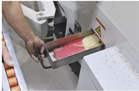
/ Der Glu-Jet-Auffangbehälter sorgt für sauberen und komfortablen Spülvorgang beim Klebstoffwechsel.
