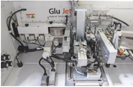
/ Dünnfilm-Technik mit Düse: Die Glu-Jet-Kleberauftragsstation verarbeitet EVA- und PUR-Klebstoffe ohne zusätzliche Leimbecken.
