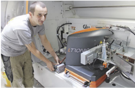
/ ... über eine präzise HSK-Schnittstelle einfach angedockt und ist danach auch sofort wieder betriebsbereit.
