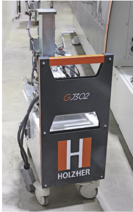
/ ... und auf den Wechselwagen gezogen. Dort kann auch die Auftragsdüse ohne großen Aufwand gereinigt werden.
