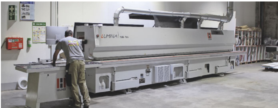
/ Mit einwechselbarem NIR-Modul LTronic für Laserkanten für alle Fälle gerüstet: Der Kantenleimautomat Lumina 1586 flex von Holz-Her präsentiert sich in der Schreinerei Braun als sehr flexibler Allrounder.
