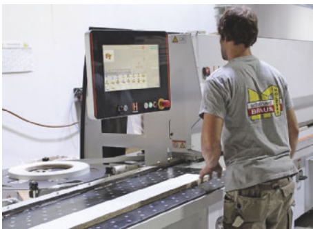
/ Sorgt für einfache Bedienung mit grafisch unterstützter Oberfläche: Die Steuerung Edge-Control mit großem Touchscreen.
