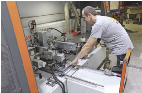
/ Schneller Wechsel über die präzise HSK-Schnittstelle: Das Glu-Jet-Aggregat wird mit wenigen Handgriffen einfach entkoppelt ...
