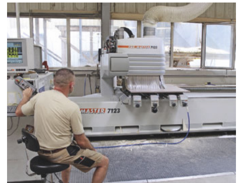
/ Zwei CNC-Bearbeitungszentren von Holz-Her leisten in der Schreinerei Braun komplette Platten- und Massivholzbearbeitung.
